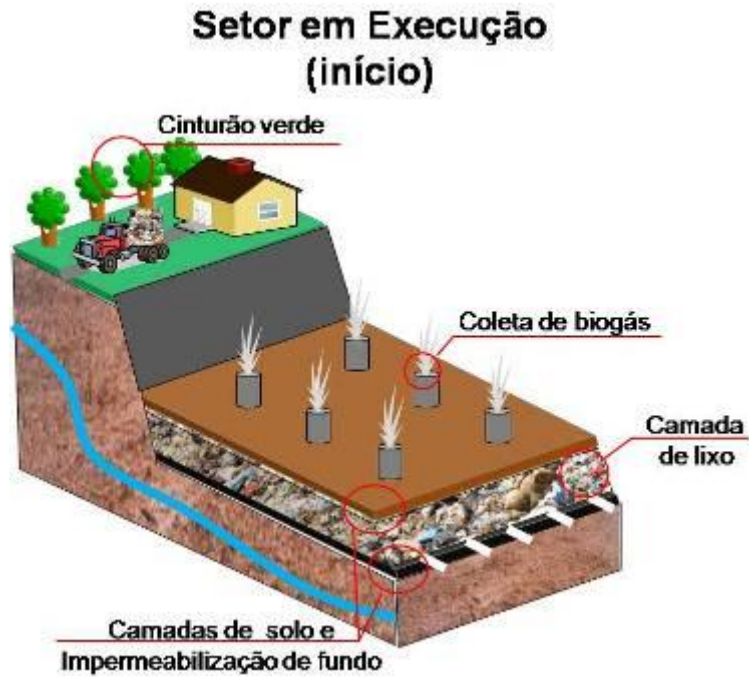
Figura 3.11b – Desenho esquemático de um aterro sanitário – setor em execução (início)
