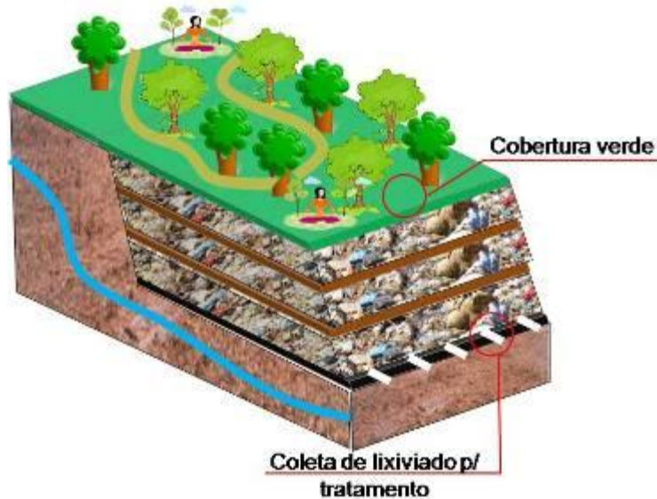
Figura 3.11d – Desenho esquemático de um aterro sanitário – aterro finalizado
