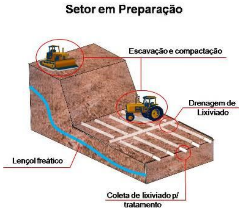
Figura 3.11a – Desenho esquemático de um aterro sanitário – setor em preparação
