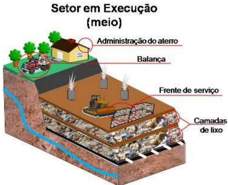
Figura 3.11c – Desenho esquemático de um aterro sanitário – setor em execução (meio)
