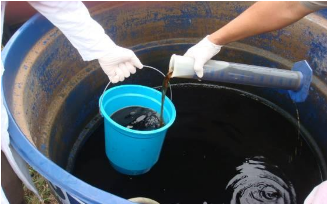
Figura 4.18 – Tanque aerado de 1000 L para 3º ensaio de stripping de amônia - abastecimento
