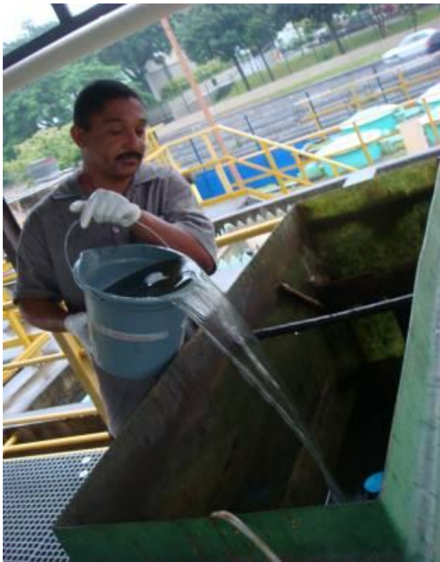
Figura 4.15 – 1º Ensaio de volatilização de amônia – abastecimento do tanque
