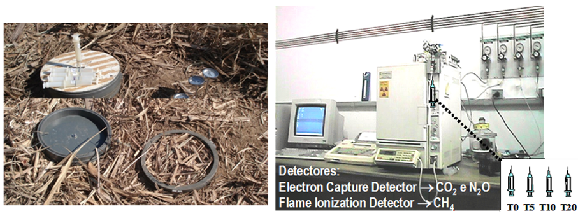
Figura 4. Dispositivo de coleta das amostras de gases no campo e análise cromatográfica no laboratório
