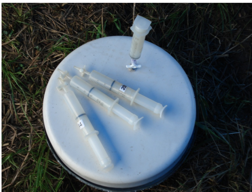
Figura 8 - Coleta das amostras de gases realizada com seringas. Ariquemes, RO. 2009
