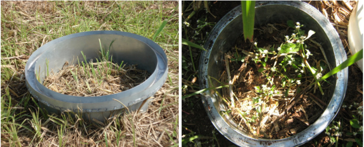
Figura 1 – Bases das câmaras utilizada para coleta dos gases provenientes dos dejetos de bovinos. Piracicaba, SP. 2009
