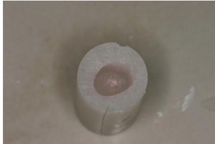
**Figura 17 - corpo de resina acrílica após remoção da cera**
