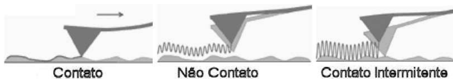
Figura 1.4: Figura ilustrativa dos modos de operação do aparato da AFM.[6]
