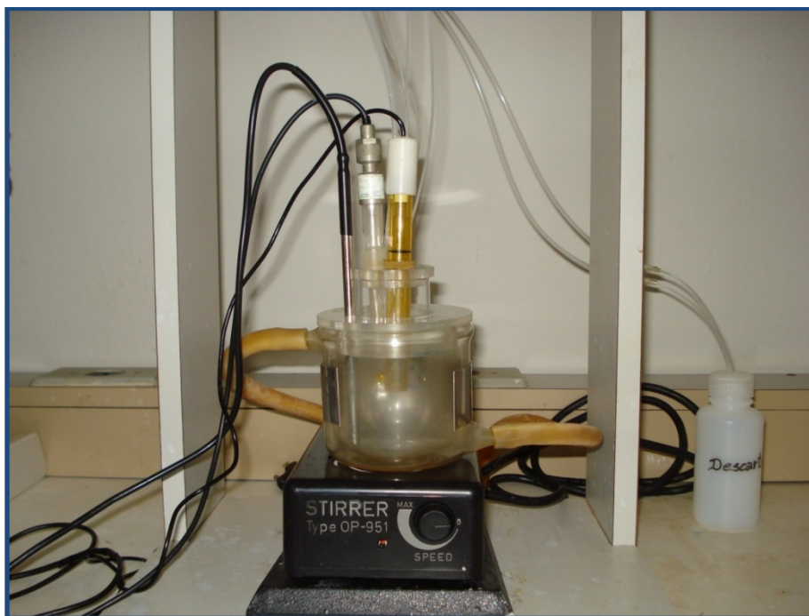
Figura 10. Cella utilizada para determinação de paracetamol.
