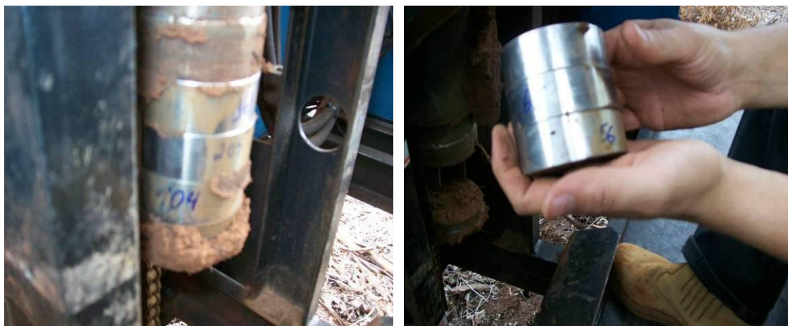
Figura 3. Ferramenta da Unidade Móvel de Amostragem do Solo (UMAS) utilizada para obtenção de anéis com amostras para a determinação de atributos do solo.
