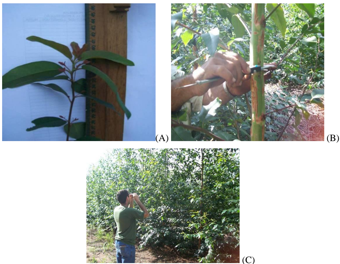
Figura 6. Régua graduada utilizada na medição da altura das mudas (A), até os nove meses de idade, paquímetro digital para mensuração do diâmetro (B) e clinômetro digital (C) para medições de altura a partir do décimo mês.
