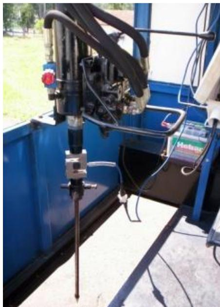
Figura 7. Penetrômetro hidráulico-eletrônico instalado na UMAS – Unidade Móvel de Amostragem do Solo.
