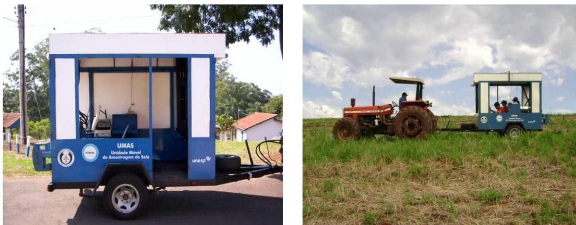
Figura 4. Unidade Móvel de Amostragem do solo (UMAS).
