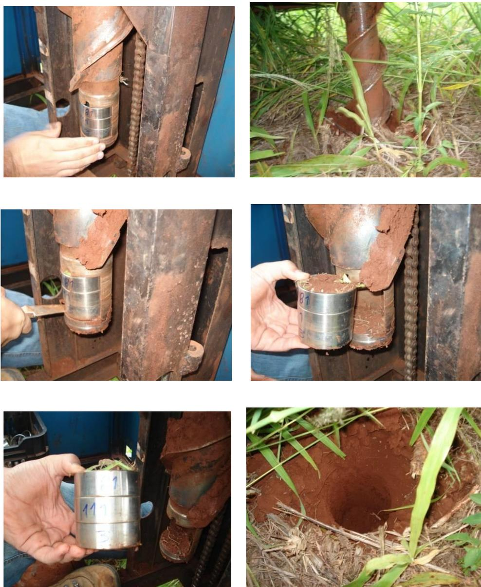
Figura 5. Coleta de anéis para compressibilidade com a UMAS.
