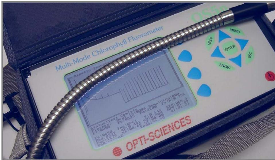
**Figura 17.** Painel frontal do fluorômetro portátil OS5p. Botucatu/SP - 2010.
