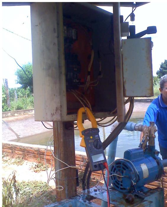
**FIGURA 5.** Wattímetro alicate instalado em uma das fases.
