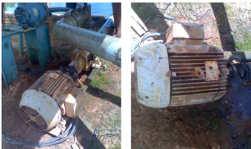
**FIGURA 6.** Motores com acoplamentos danificados e assentados ao chão
