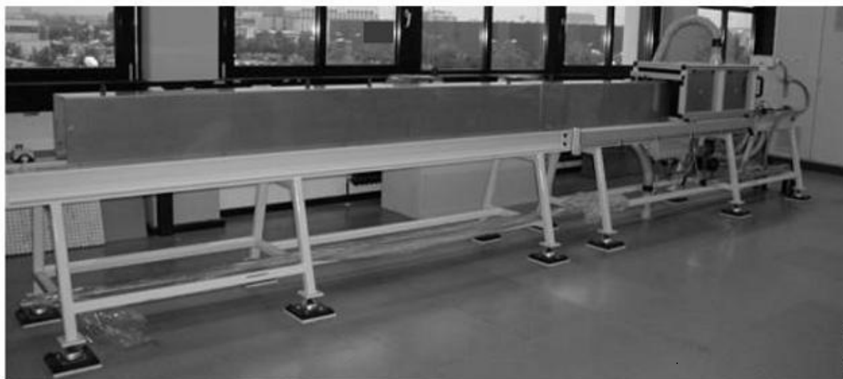
Figura 43 Banco de provas da ZF Sachs na Alemanha para teste de judder
