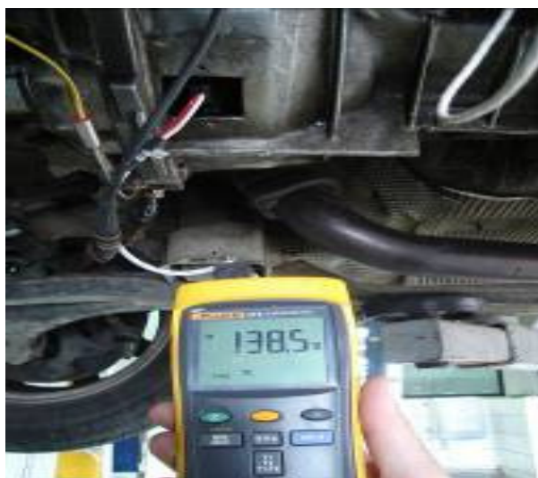
Figura 80 Detalhe da medição da temperatura e abertura da caixa seca
