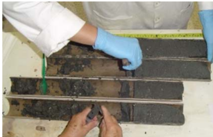
Figura 8 - Testemunhos sendo seccionados ao meio e sendo fatiados em camadas de 2 cm de espessura
