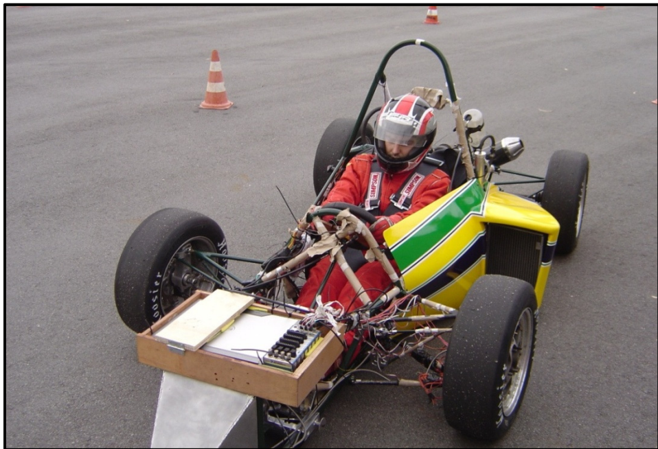
Figura 53 – Protótipo RS3 equipado com o sistema de aquisição de dados da NI. Fonte: Cortesia Fórmula FEI.
