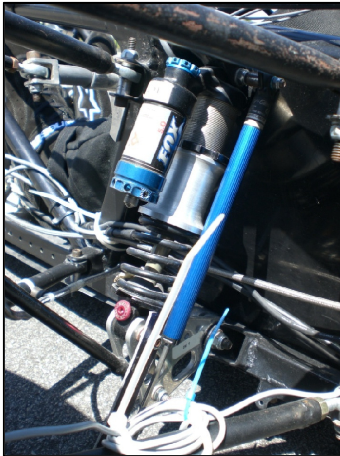
Figura 65 – Instalação do LVDT no RS3. Fonte: Autor.
