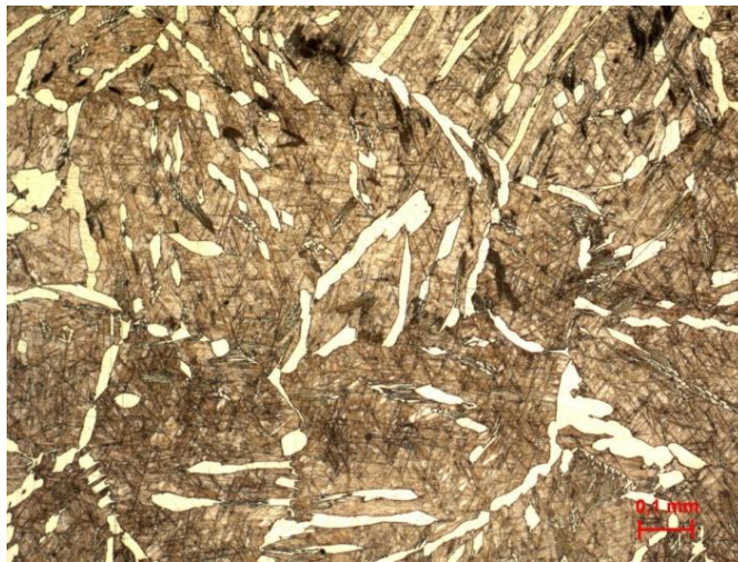
Figura 54 – Homogeneizado, aquecido a 900 °C por 15 min. e temperado em água. Região da borda de corpo de prova na forma de fino gume. Martensita e fase \alpha . MO. Ataque: percloroeto de ferro e dicromato de potássio.
