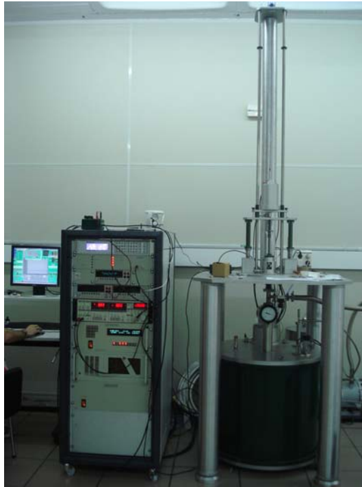
Figura 3.5 Equipamento PPMS (Quantum Design) utilizado nas medidas de magnetização das amostras (Universidad del Pais Vasco, Espanha).
