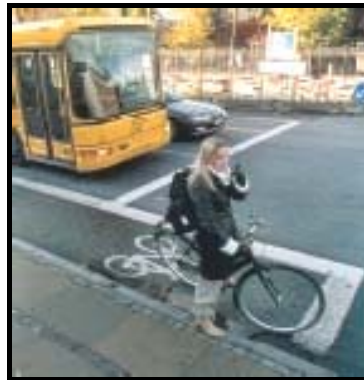
Figura 6.11: Parada avançada para bicicleta.
