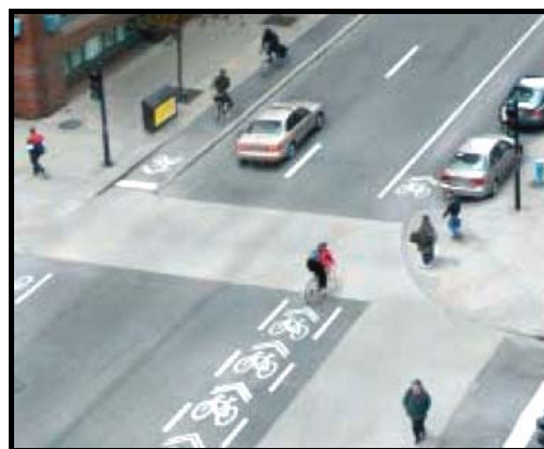
Figura 6.30: Tipo de marcação de interseção (2)
