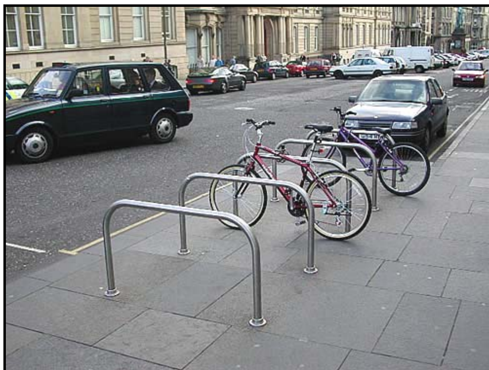
Figura 7.28: Estacionamento tipo suporte (“U” invertido).
