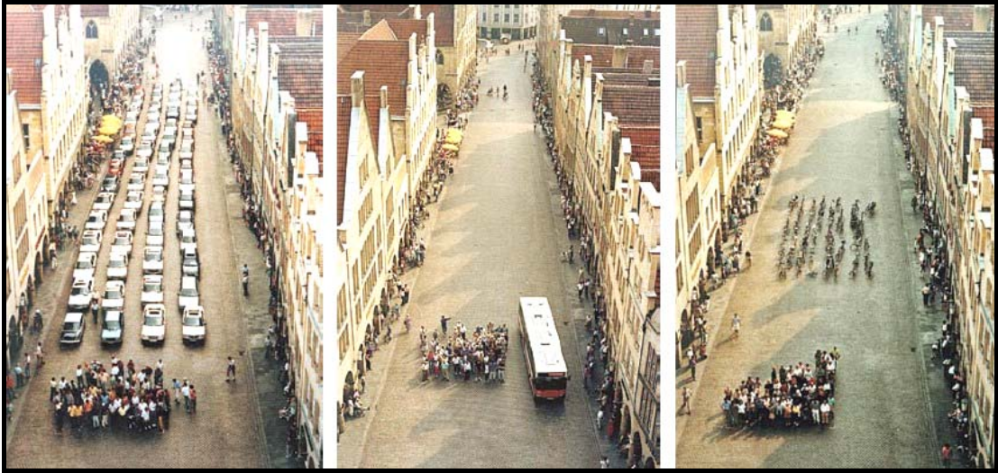
Figura 2.2: Diferenças no espaço ocupado, de acordo com o tipo de veículo.
