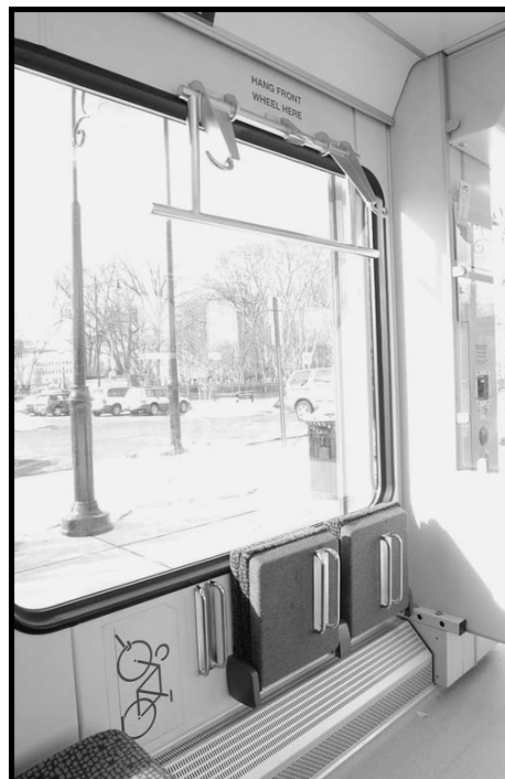
Figura 8.9: Detalhe da área de acomodação de bicicleta.
