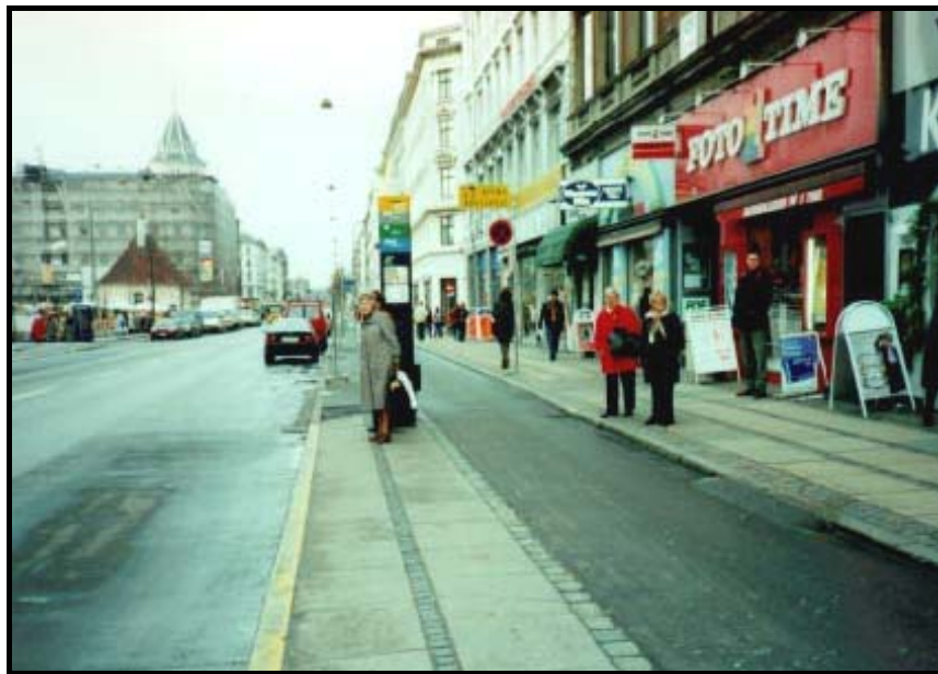
Figura 5.31: Ponto de parada de ônibus com ciclovia passando por trás.
