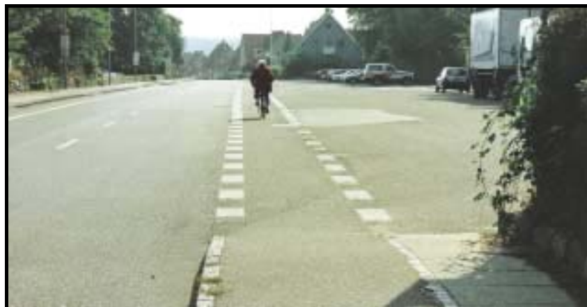
Figura 5.21: Transição suave de ciclovia para ciclofaixa.
