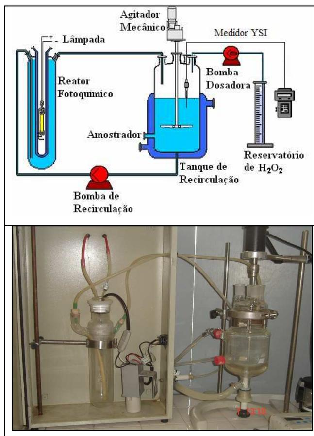
Figura 4.1. Esquema de reator foto-Fenton. Cedida por Cardeña (2009)
