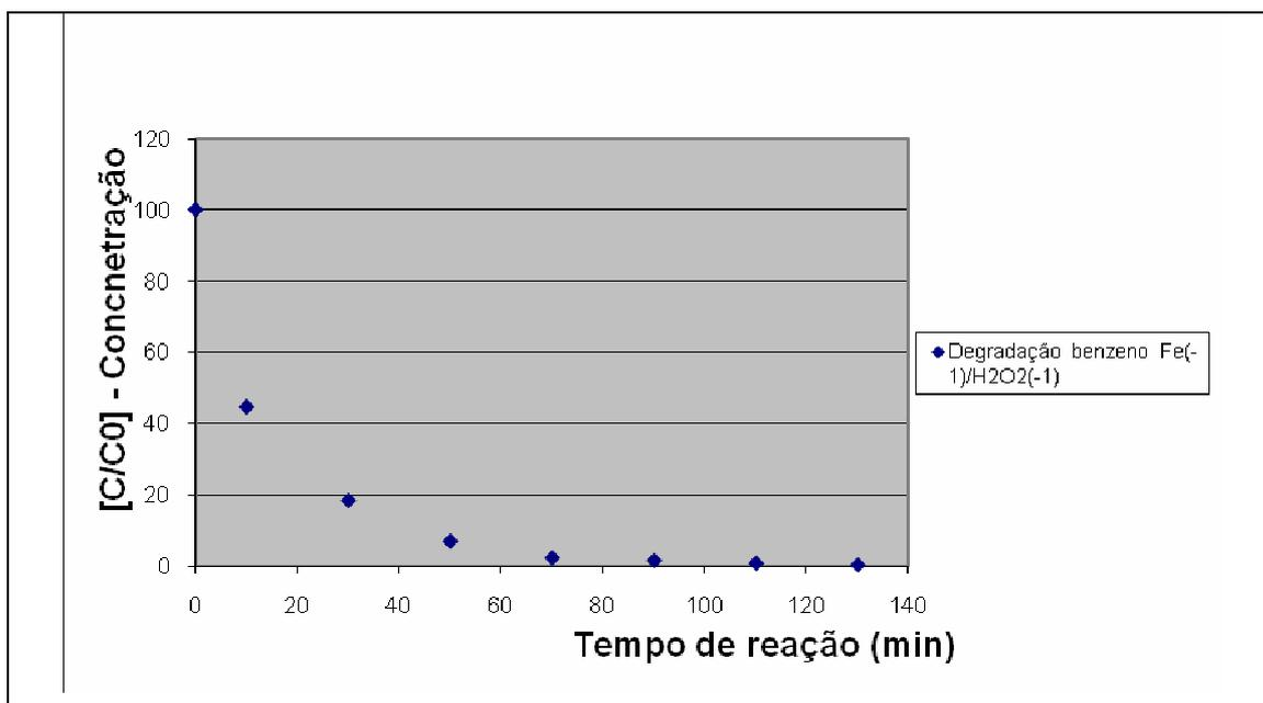
Gráfico 5.12. Degradação benzeno Fe(-1)/H<sub>2</sub>O<sub>2</sub>(-1)
