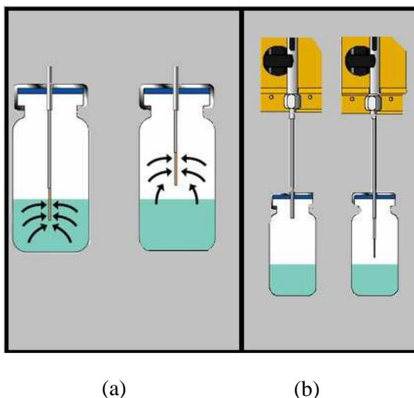
Figura 2.5. [Processo de extração] a) Modo direto, b) Modo de extração via fase gasosa
