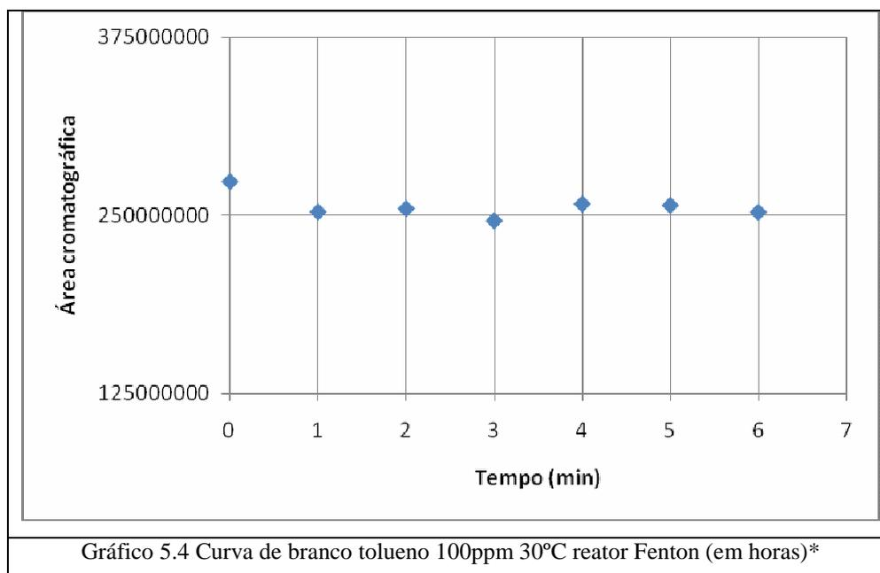
A curva de branco para o composto tolueno à temperatura de 30°C mostra que praticamente não há perdas desse composto para o ambiente com o uso do reator Fenton, diferente dos valores acima, quando se tratava de reator foto-Fenton.
