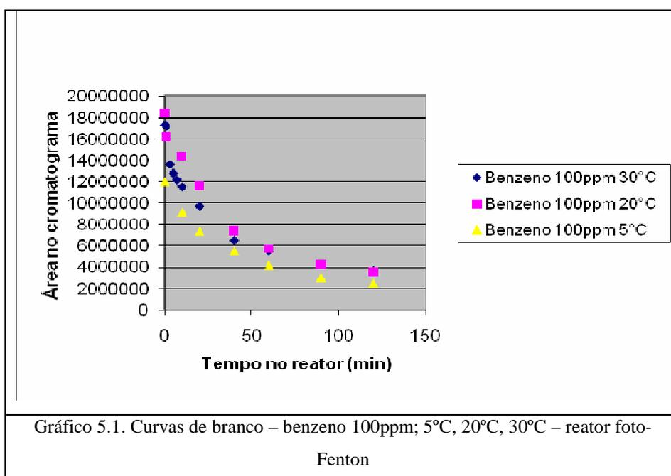
A curva de branco de benzeno mostra uma grande perda de área, dentro do reator, com o tempo. Indicando, portanto que a fase orgânica presente na fase líquida, está sendo transferida para a fase vapor, e esta última está sendo transferida para atmosfera, pois o reator não é totalmente vedado.
