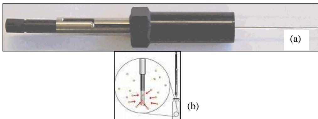
Figura 2.4. [Aparato SPME] a) Suporte b)Fibra em contato com amostra
