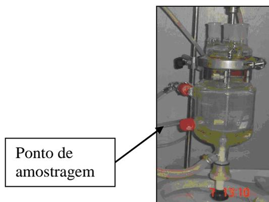
Figura 4.2. Ponto de amostragem do reator foto-Fenton
