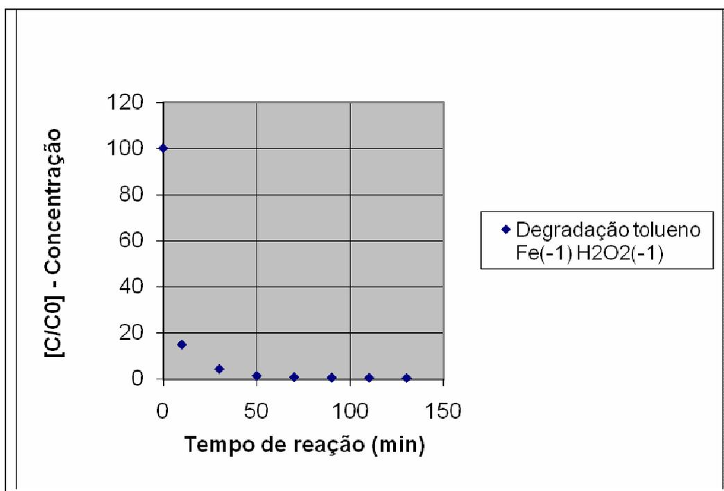
Gráfico 5.5. Degradação tolueno Fe(-1)/H<sub>2</sub>O<sub>2</sub>(-1)
