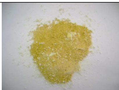
Figura 4.2. Catalisador de cloreto de cobre II suportado em sílica.
