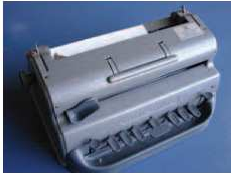
Figura 14: Imagem da máquina de escrever para escrita em Braille (IBC, 2010).
