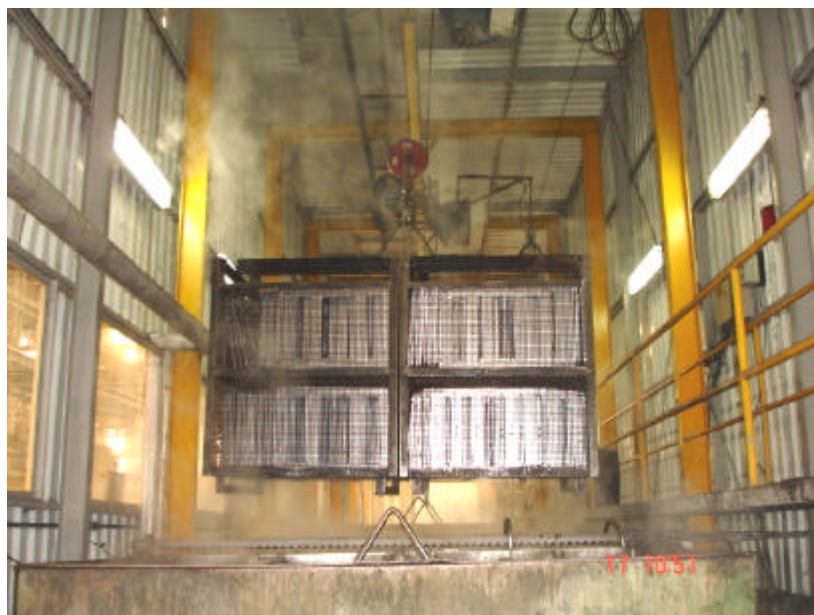
Figura 38: Foto ilustrativa do processo de pré-tratamento por imersão em tanques. Fonte: Araujo, 2006. Cortesia BSH Continental Ltda.
