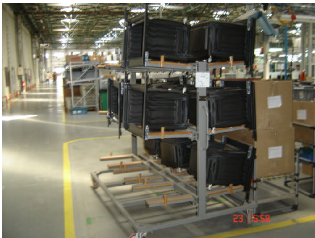
Figura 8 : Foto ilustrando cavidades esmaltadas para forno de fogões Fonte: Próprio autor, 2006 – Cortesia da BSH Continental Ltda.
