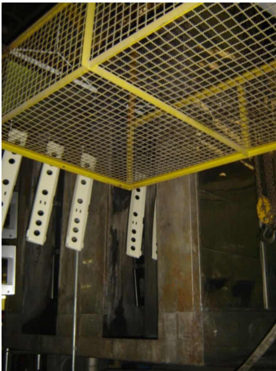
Figura 36: Foto ilustrando peças dependurada em gancheras presas em transportador aéreo tubular.
