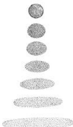
Figura 26: Desenho ilustrativo do formato dos leques produzidos pelas pistolas de aplicação.
