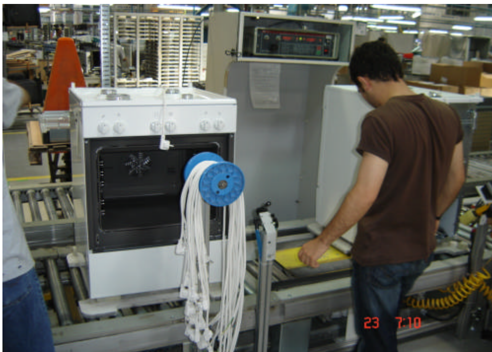
Figura 9: Foto ilustrando típica linha de montagem de fogões Fonte: Próprio autor, 2006 – Cortesia da BSH Continental Ltda.
