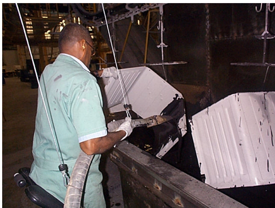
Figura 29: Foto ilustrando o método de aplicação com bico de pato. Fonte: Próprio autor. Cortesia da BSH Continental Ltda.
