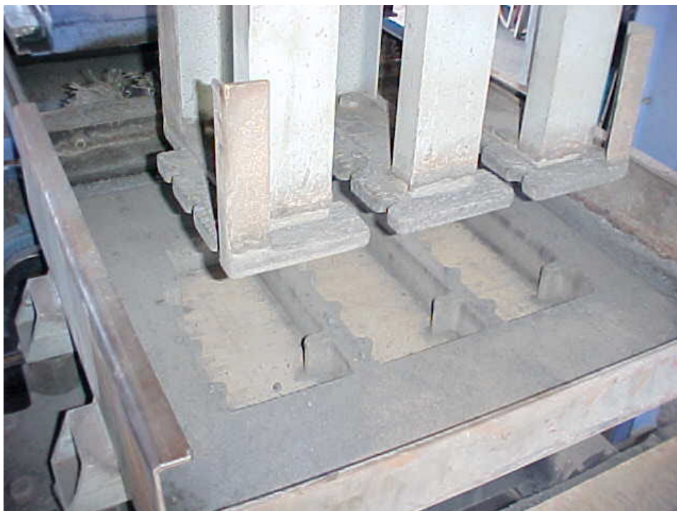
Figura 57: Foto de detalhe do molde de fabricação de contrapeso de fogão. Fonte: Próprio autor, 2003.
