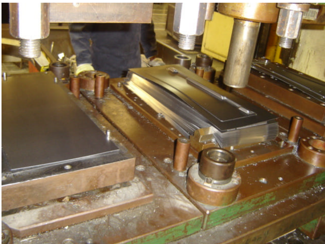
Figura 6: Foto ilustrando detalhe ferramenta dentro da prensa, blank (chapa lisa) a esquerda e peça após conformada a direita. Fonte: Próprio autor, 2006 – Cortesia BSH Continental Ltda.
