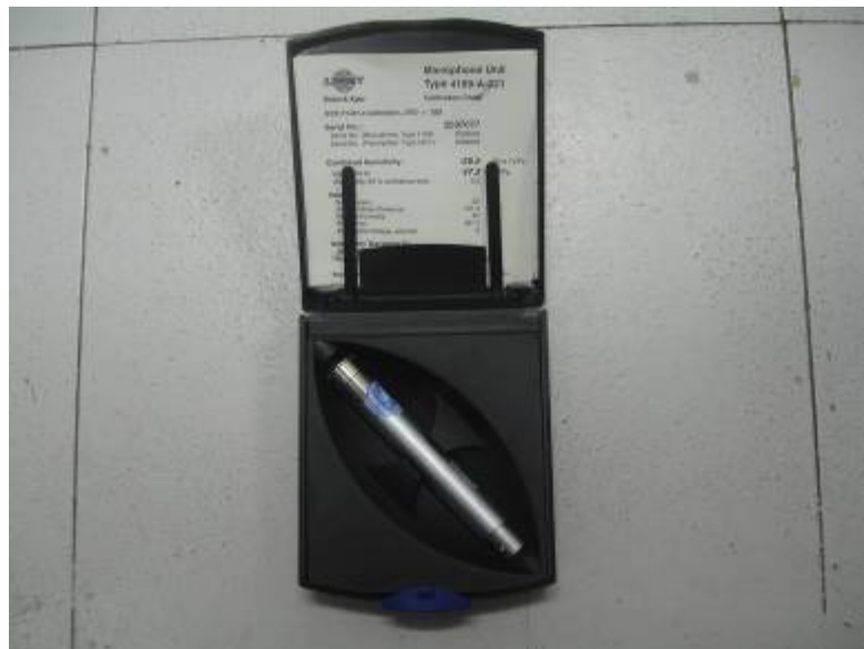
Figura 5.12 - Microfones Type 4189-A-021, Marca Brüel & Kjaer
