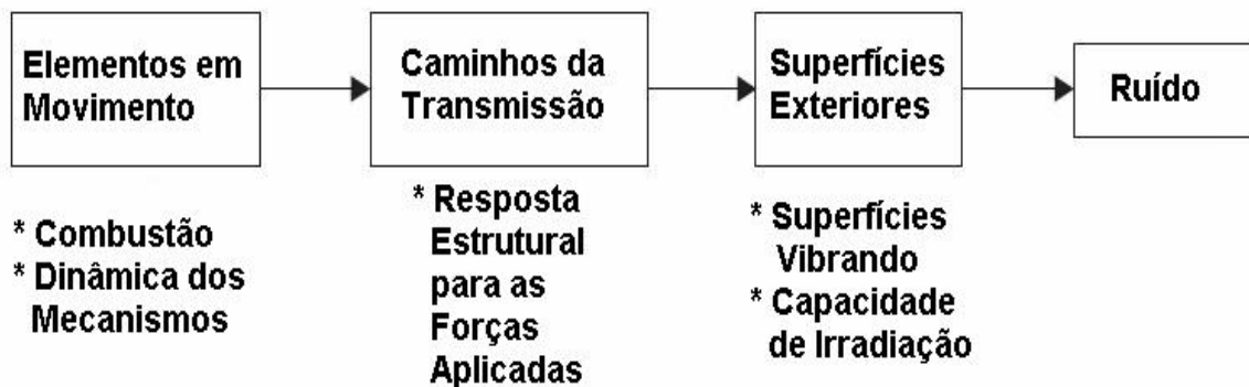
Figura 3.2 - Diagrama de blocos do modelo de geração de ruído do motor.
