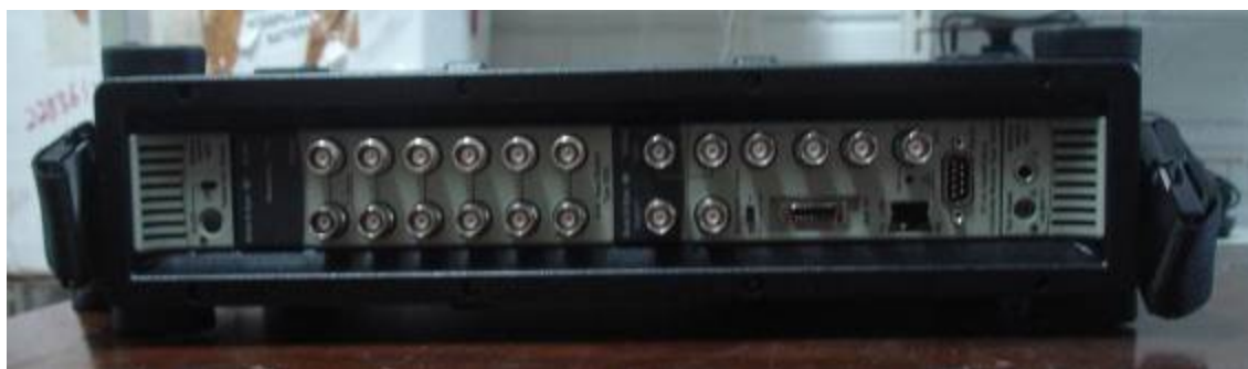
Figura 5.14 - Sistema de aquisição e análise PULSE Type 3560 com doze canais.
