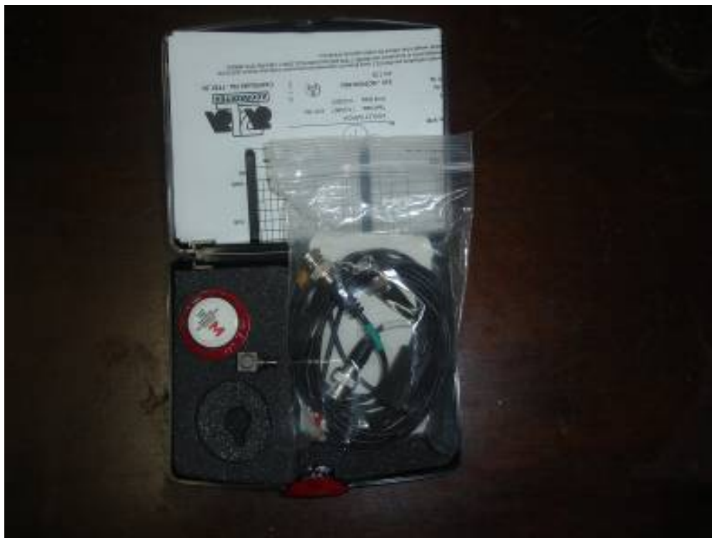
Figura 5.13 - Acelerômetros triaxiais Model 65-10, Marca Isotron
