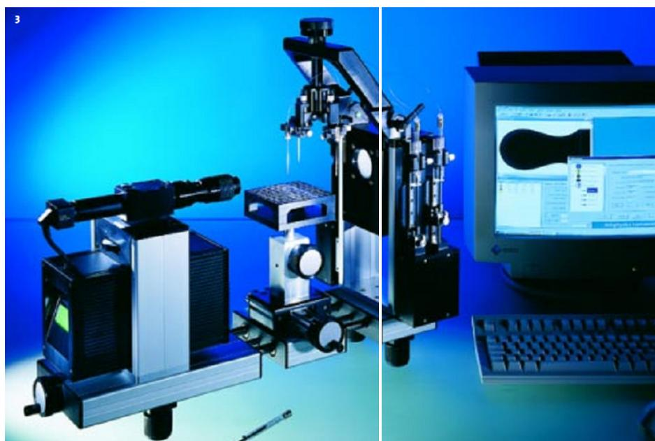
**Figura 3.5:** Equipamento *OCA-20* para medida de tensão superficial pelo método da gota pendente [70].
