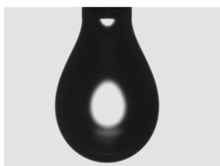
**Figura 3.6:** Exemplo de imagem da gota pendente que é utilizada pelo *software* para o cálculo da tensão superficial da gota.
