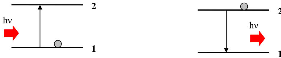
Figura 2.1. Diagrama esquemático de dois níveis de energia. À esquerda, representação do fenômeno de absorção. À direita, emissão espontânea.
