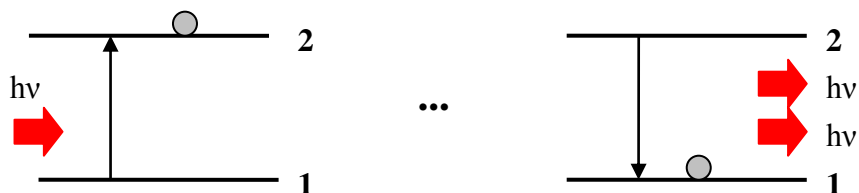
Figura 2.2. Diagrama esquemático de dois níveis de energia, representando emissão estimulada.
