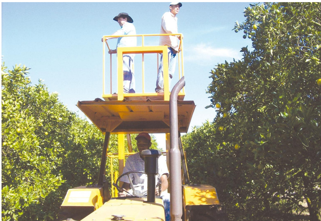
Figura 1.3. Trator com plataforma, usado na inspeção do greening [JORNAL DA CIDADE DE HOLAMBRA, 2009].
