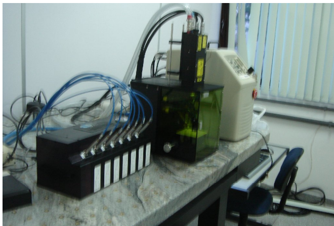
Figura 4.5. Imagem do equipamento LIBS. À esquerda estão os espectrômetros; no centro, a câmara de ablação; à direita, a fonte do laser de Nd:YAG.
