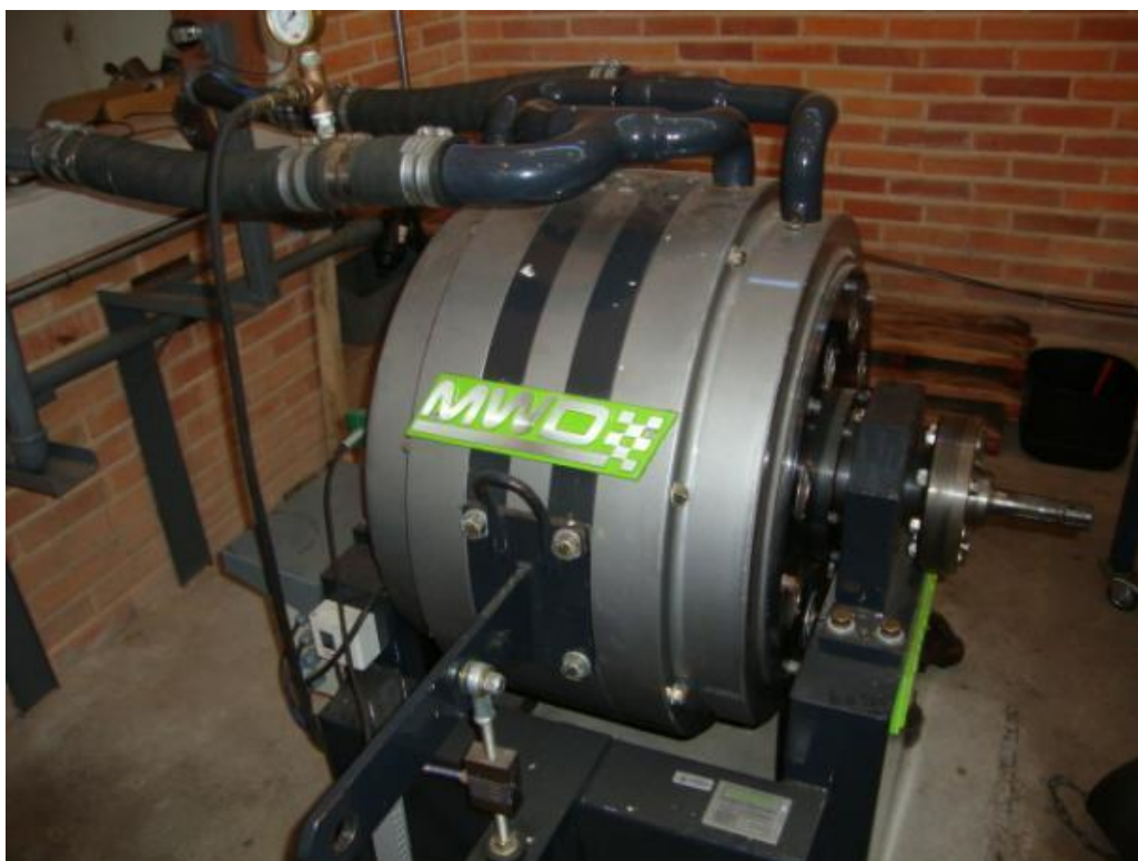
Figura 4- Dinamômetro de correntes parasitas utilizado nos ensaios.
