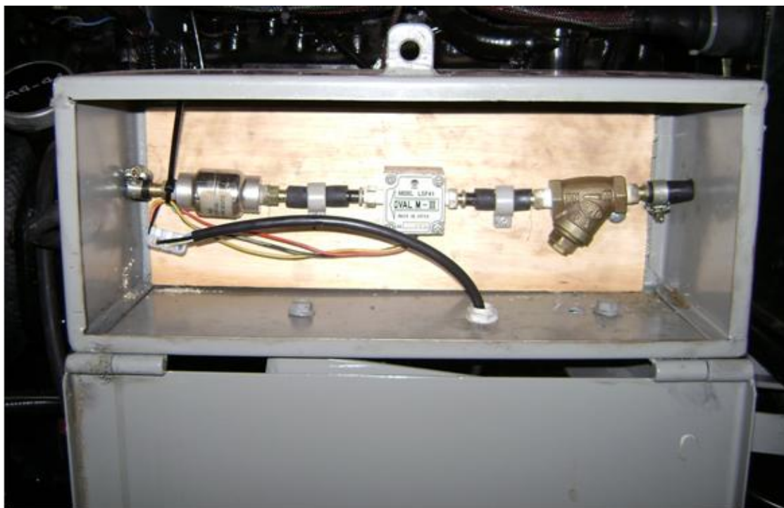
Figura 10- Fluxômetro utilizado nas medições de consumo horário de combustível (L/h).
