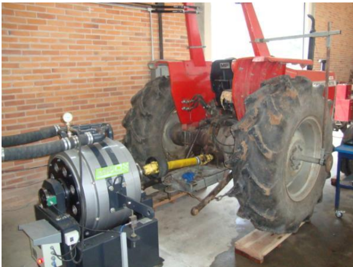
Figura 6- Trator MF 275 acoplado ao dinamômetro de correntes parasitas NL 480.
