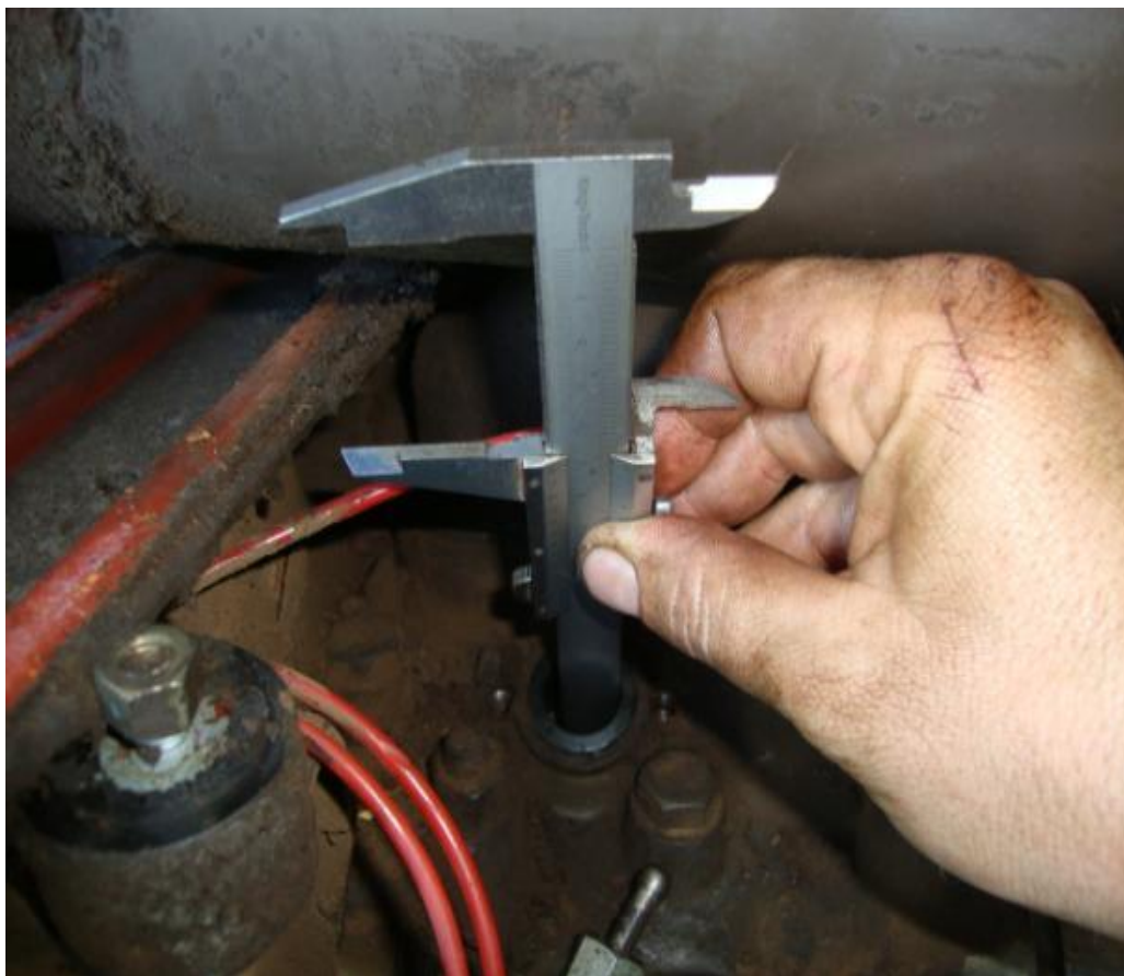
Figura 11- Identificação do PMS referencial e do novo PMS (ponto de avanço da injeção adiantado).
