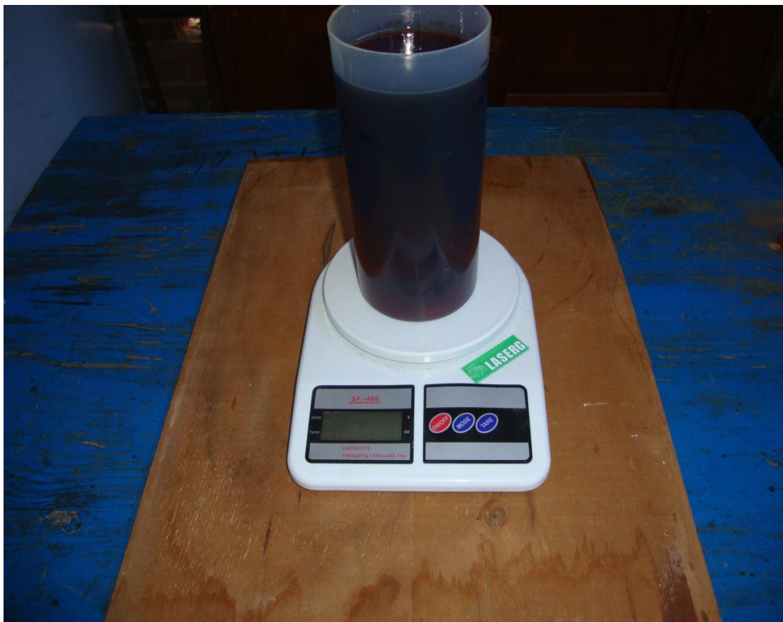
Figura 7- Procedimento de pesagem para determinação da densidade do óleo diesel.
