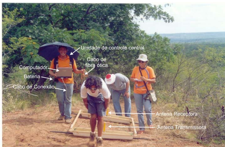
Fotografia 1.1: Trabalho de campo para a obtenção de um perfil de reflexão GPR no afloramento CAB-2, com antenas de frequências centrais em 100Mhz.
