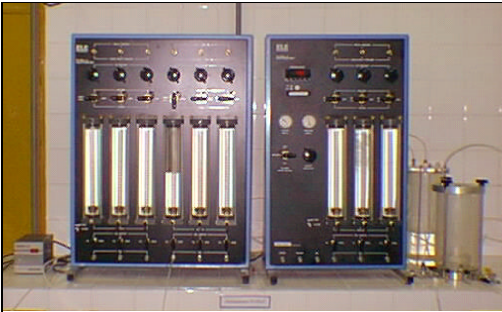
Figura IV.6 – Ensaio de condutividade hidráulica com o Tri Flex 2
