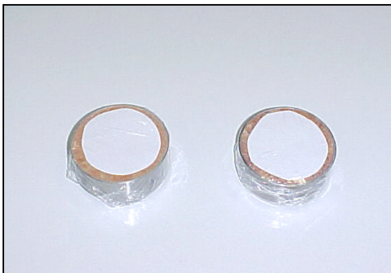
Figura B.1 – Preparação das amostras com papel filtro, para obtenção dos pontos de sucção.
