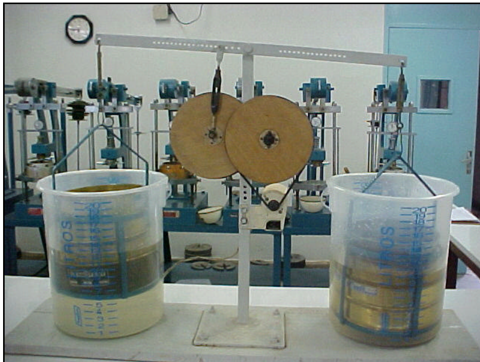
Figura IV.24 – Ensaio de estabilidade de agregados – execução do peneiramento múltiplo submerso.
