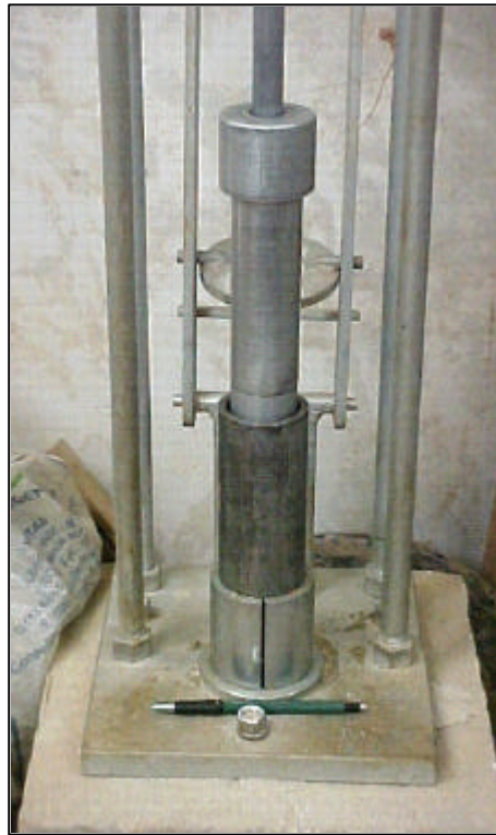
Figura IV.10 – Compactação das amostras no ensaio MCT
