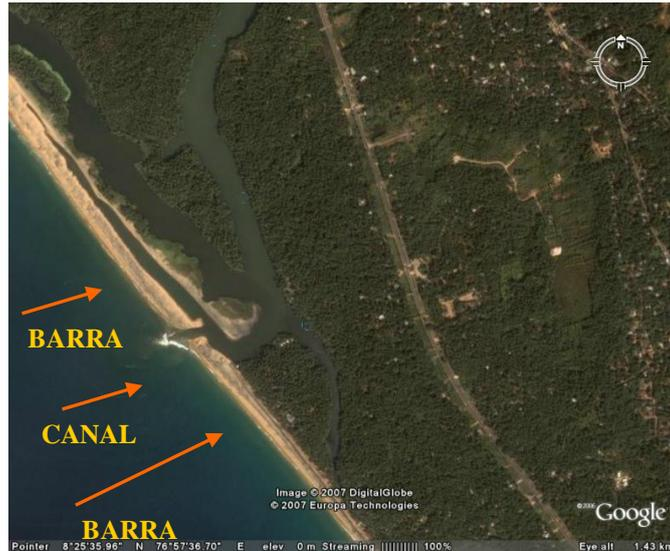
Figura 3.8: Estuário *Vellar* na Índia. Na imagem, o canal formado pela estreita abertura na extensa barra, desenvolvida ao longo da costa, permite fluxo hídrico entre o mar e o rio (Fonte: *Google Earth*, 15/09/2006).
