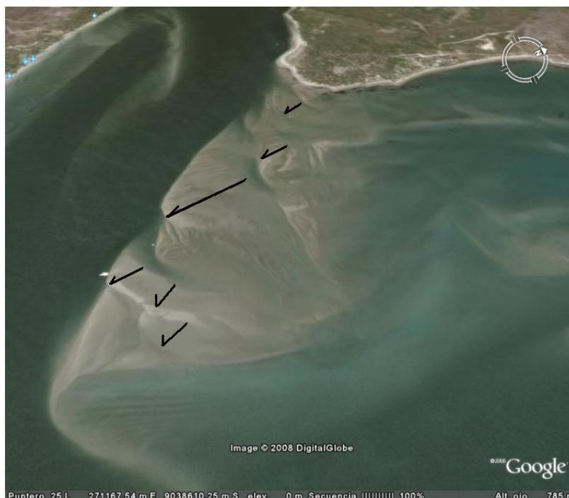
Figura 6.26 – Pontal de Guadalupe. Setas indicam a direção de desenvolvimento das marcas de ondas, resultante do padrão preferencial da deriva litorânea e do barramento hidráulico constituída pela vazão estuarina.
