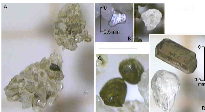
Figura 27: A - grãos de quartzo agregados à caulinita, B - grãos de mica; C - limonita; D - grão de quartzo e turmalina.
