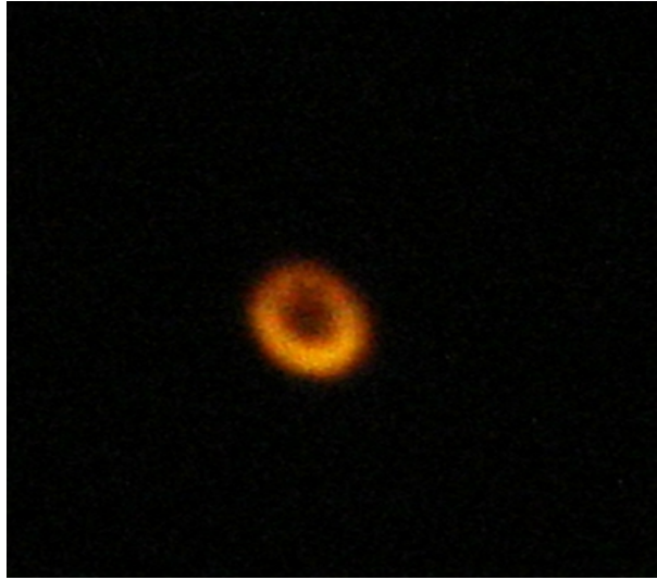
figura 25: Perfil de intensidade em campo próximo para um feixe na face de saída da cubeta com água; Foto tirada para amostra de água colocada na posição do mínimo de transmitância. W_0 = 30\mu\text{m} , cubeta de 1 mm.
