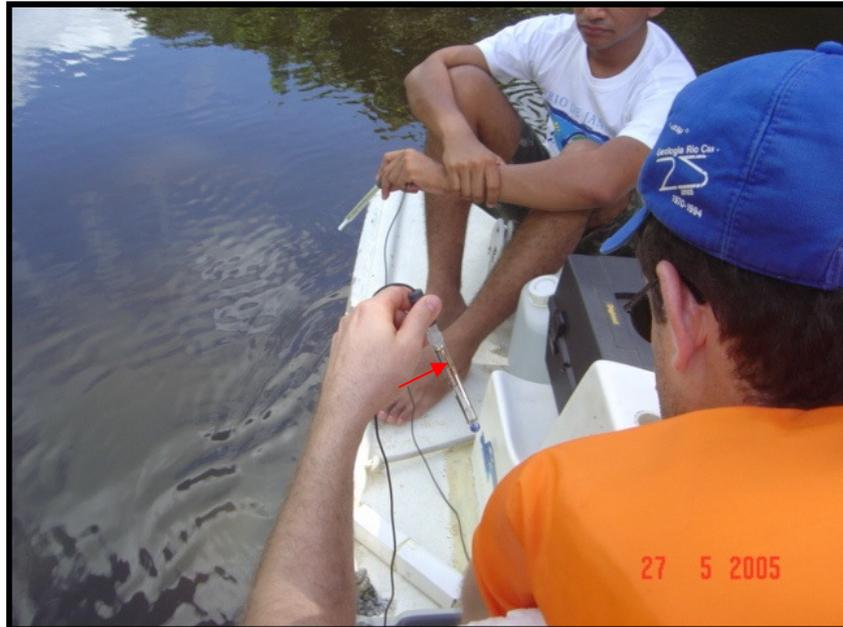
Figura 31 – Medição físico-química da água usando sonda portátil multi-paramétrica.
