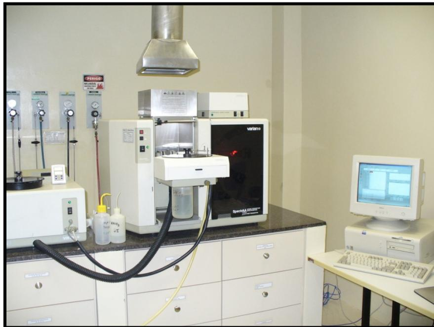
Figura 36 - Espectrômetro de Absorção Atômica.
