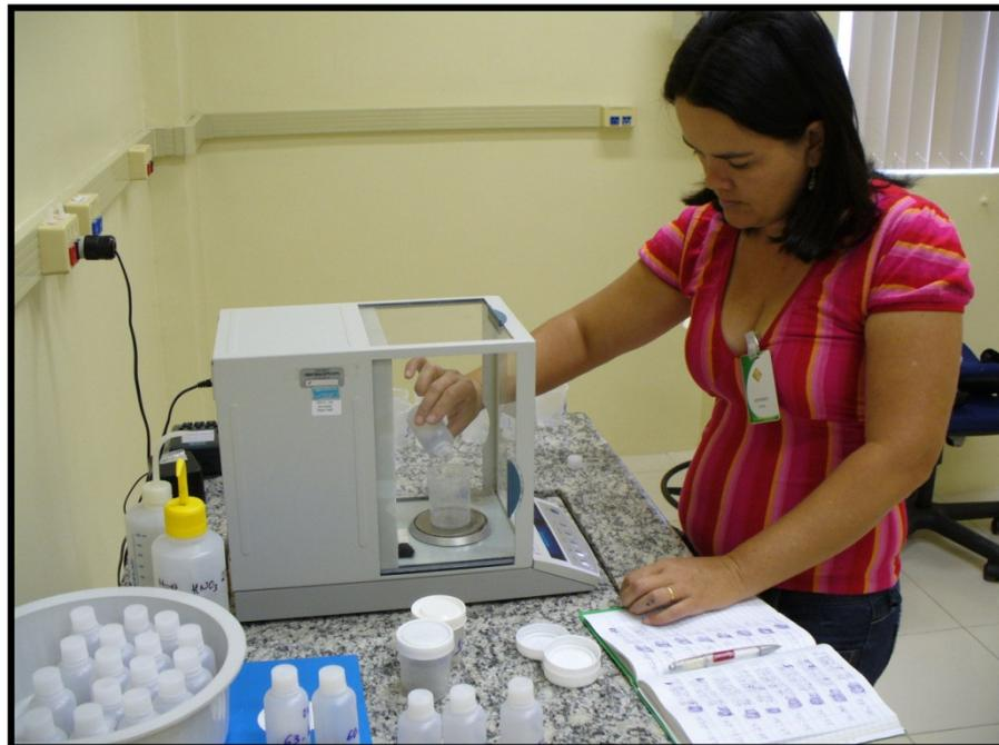
Figura 40 – Processo de pesagem das amostras para a digestão geoquímica.
