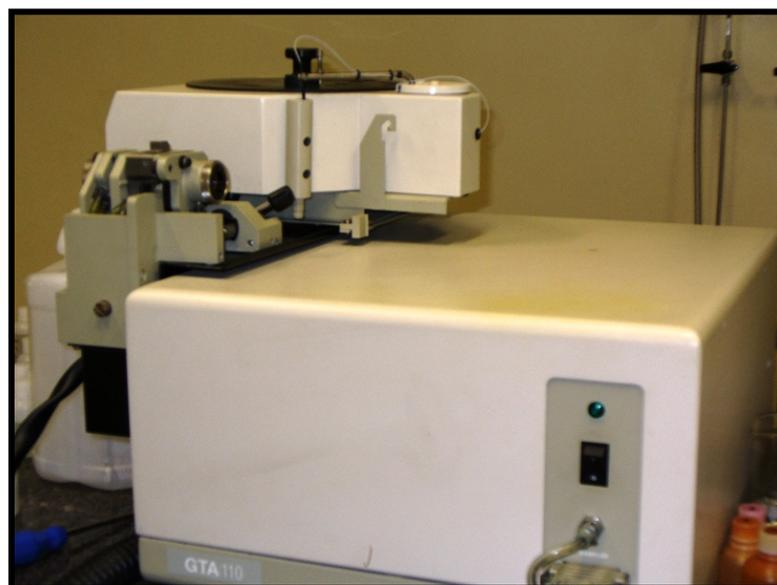
Figura 37 - Acessório Graphite Furnace GTA 110.
