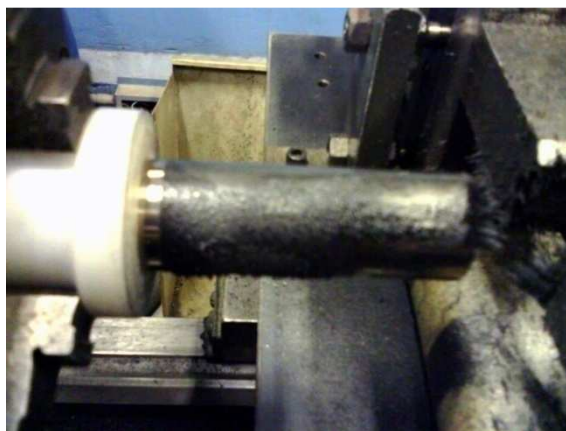
Figura 5.18 – Corpo de prova após usinagem com 16% de óleo PBS33, a 800 RPM.
