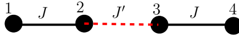
Figura F.1 – Cadeia de quatro spins 1/2. Os sítios 1 e 2 e os sítios 3 e 4 representam duas cadeias de dois sítios desacopladas, tratadas como sistema não perturbado do Hamiltoniano de quatro sítios. O acoplamento representado pela ligação J' , tracejado na figura, é tratado como perturbação na teoria.
