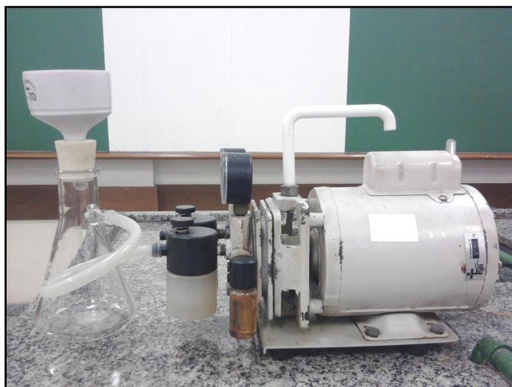
**Figura 20.** Aparato experimental utilizado nas etapas de filtração e lavagem das amostras.
