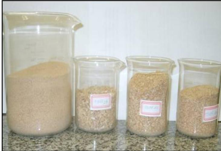
**Figura 18.** Separação das amostras por granulometria
