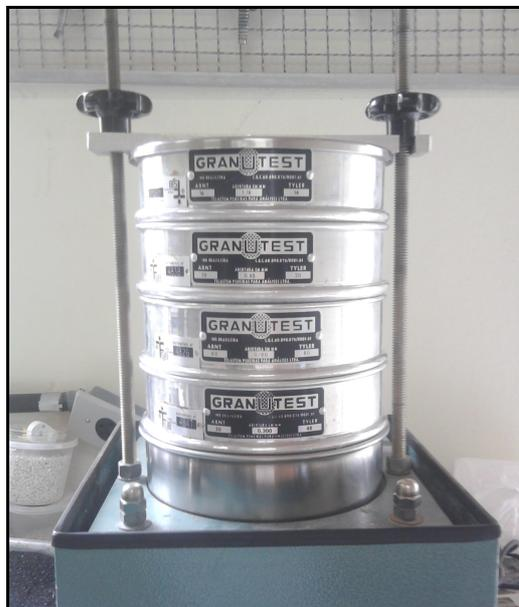
**Figura 19 -** Sistema de peneira utilizado na separação granulométrica
