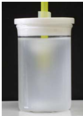
Figura 7 - Reprodução de análise de ponto de névoa no final do processo de enfraquecimento das ligações das moléculas de água com o ramal polioxiadoetilênico (Ponto de névoa).
