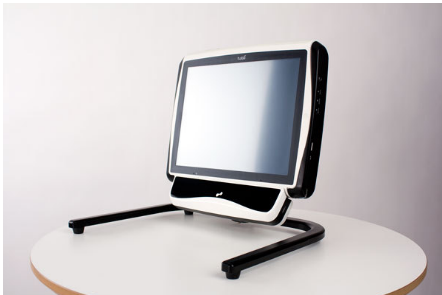
Figura.2 Modelo Tobii C12 com câmera, software e iluminação infravermelha incorporados.
