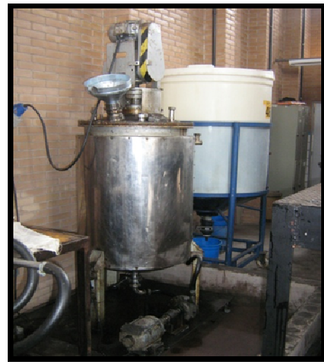
Figura 4.1 – Reatores utilizados no processo da reação de transesterificação.
