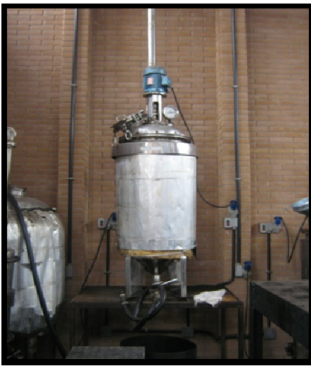
Figura 4.1 – Reatores utilizados no processo da reação de transesterificação.
