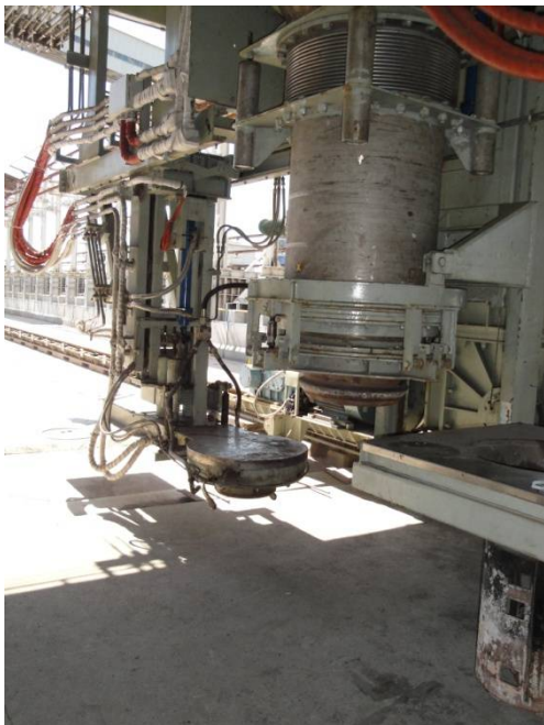
Figura5-15: Usiminas. Coqueria 03 (2010). Carro de carregamento. Extrator magnético de tampa. Acervo do autor.
