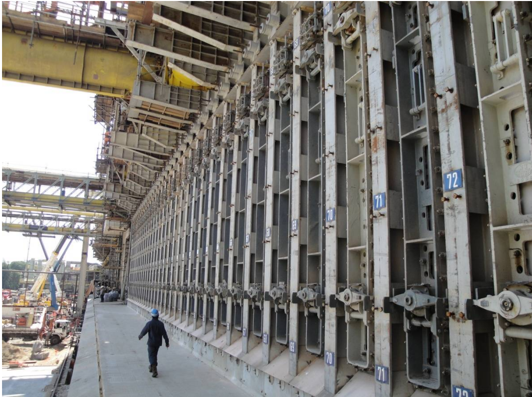
Figura 5-8: Porta de forno de coque com selagem flexível. USIMINAS (2010). Acervo do autor.
