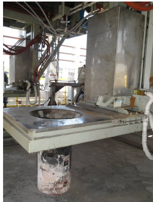
Figura5-16: Usiminas. Coqueria 03 (2010). Carro de carregamento. Raspador de boca. Acervo do autor.
