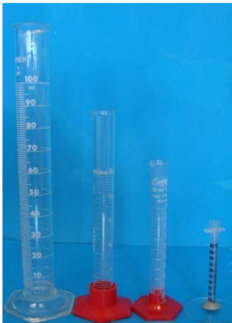
Figura 12: Vista geral das provetas de diferentes graduações (1,10, 25 e 100 ml) usadas no método volumétrico.
