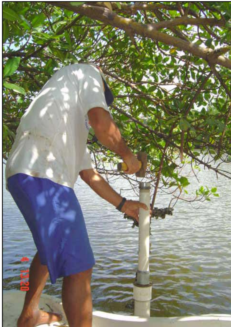
Figura 20 - Amostragem à percussão de perfil sedimentar
