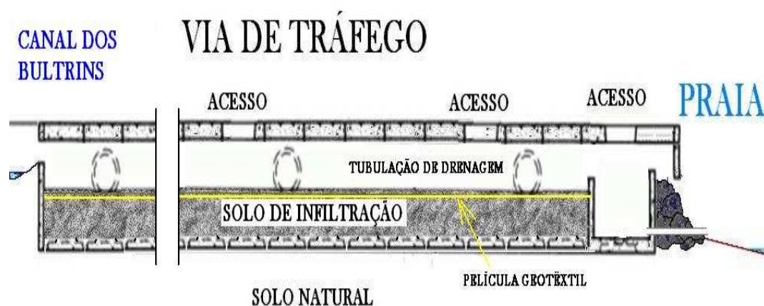
Figura 7. 3 - Sugestão de estrutura de canal de extravasamento com possibilidade de funcionar como estruturas de infiltração/percolação (Fonte: acervo do autor).
