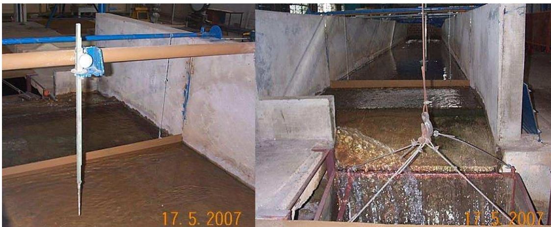
Figura 6. 7 - Viga de retenção funcionando como orifício (Foto do autor).
