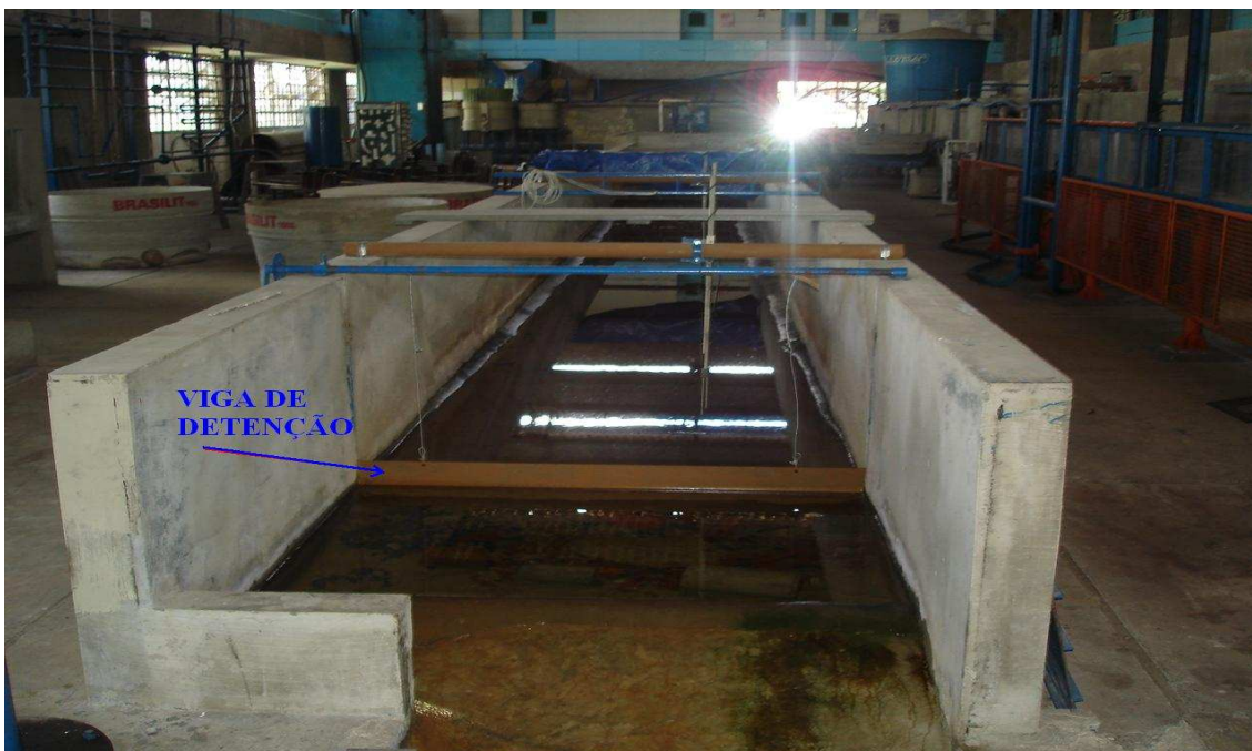
Figura 6. 5 - Canal do laboratório com viga de detenção (Foto do autor).
