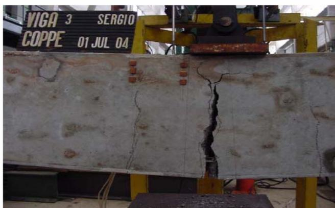
Figura 8.20 (b) Viga V1 após o ensaio (OLIVEIRA, 2005)
