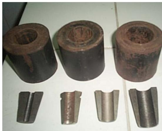
Figura 5.12 Sistema de cunhas utilizadas para os diâmetros de 8 mm, 10 mm 12,5 mm e 16 mm
