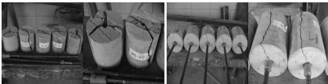
Figura 3.14 Ruptura por fendilhamento de corpos-de-prova cilíndricos (ALMEIDA FILHO, 2006)
