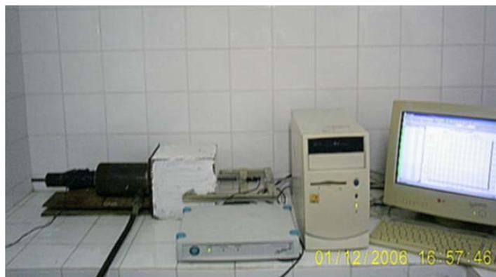
Figura 5.10 Montagem para a realização de um ensaio de arrancamento.
