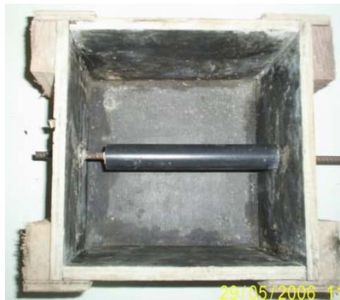
Figura 5.5 Posicionamento da barra na forma
