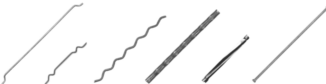
Figura 2.1 Alguns tipos de fibras de aço (WEILER, 2002)
