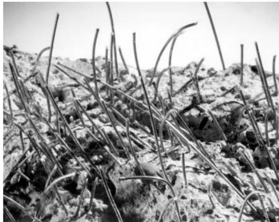
Figura 2.3 Superfície fraturada de concreto reforçado com fibras de aço (ACI 544.1R, 2004)
