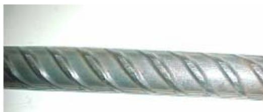
Figura 3.15 Nervuras em barra de aço para concreto armado
