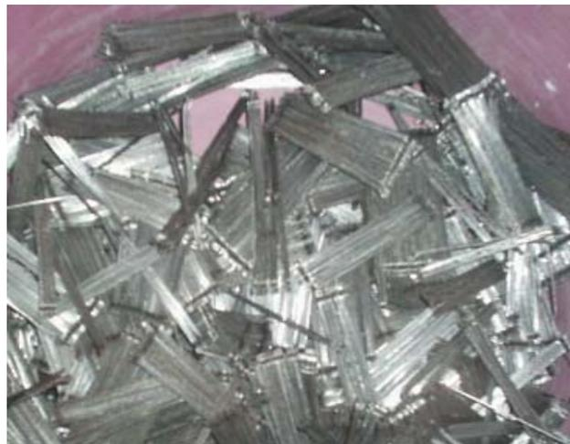
Figura 5.2 Fibras de aço coladas em pentes
