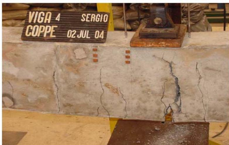
Figura 8.22 (b) Viga V2 após o ensaio (OLIVEIRA, 2005)
