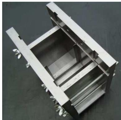
Figura 23 - Fotografia do molde de aço inoxidável utilizado na confecção das amostras para o ensaio da cunha nas análises de energia de fratura.
