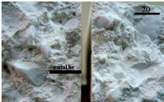
Figura 15 - Fotografia da superfície de fratura de um concreto refratário com agregados de até 22 mm, com um entalhe simulado.
