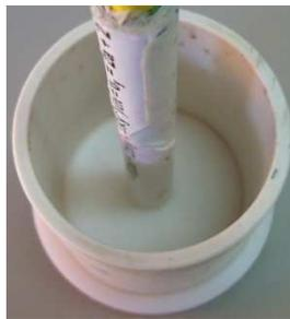
Figura 24 - Fotografia do molde para confecção das amostras cilíndricas utilizadas nas análises de coeficiente de expansão térmica linear.
