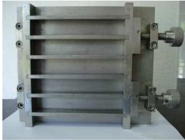
Figura 22 - Fotografia do molde para confecção das barras prismáticas para medidas de módulo elástico, módulo de ruptura, porosidade aparente, absorção de água, massa específica aparente e testes de choque térmico.
