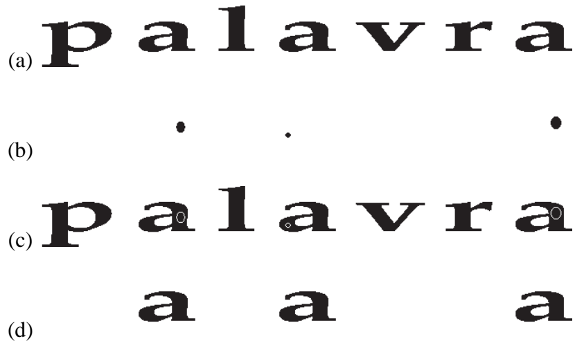
Figura 2.8: Exemplo de reconstrução morfológica: (a) imagem original; (b) imagem de marcadores; (c) sobreposição dos marcadores na imagem original para fins de visualização da posição; e (d) resultado da reconstrução, na qual somente as letras “a” foram reconstruídas.
