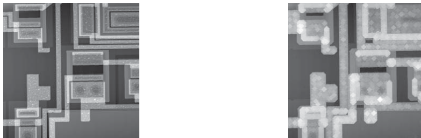
Figura 2.5: Imagem original e imagem resultante da dilatação em níveis de cinza pelo elemento estruturante do tipo diamante de tamanho 9 \times 9 .
