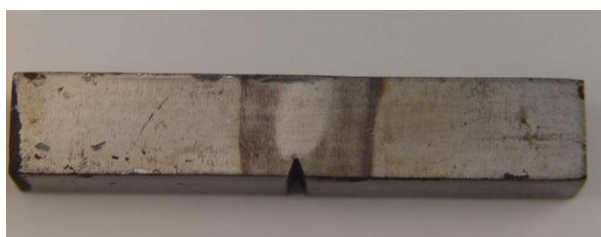
FIGURA 4.4 – Amostra utilizada para simular ciclos térmicos de soldagem na Gleeble.
