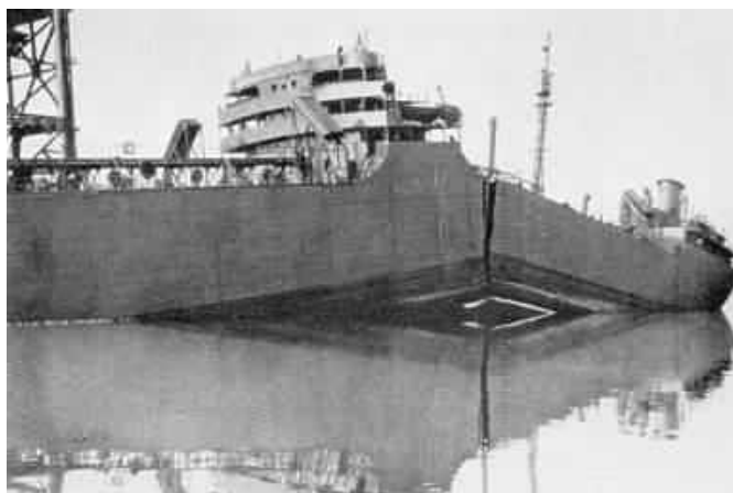
FIGURA 3.6 – Fotografia de um navio da série Liberty partido ao meio após fratura frágil (8) .
