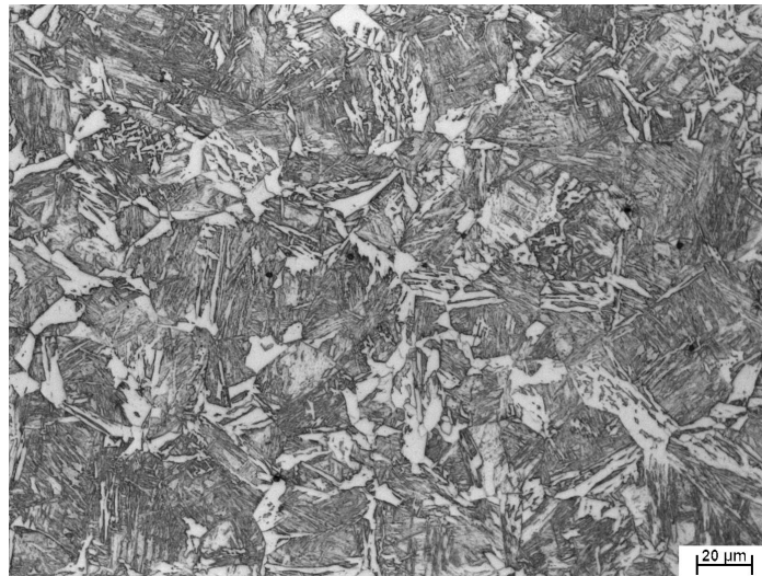
FIGURA 3.11 – Micrografia típica de ferrita de contorno de grão (região mais clara).
