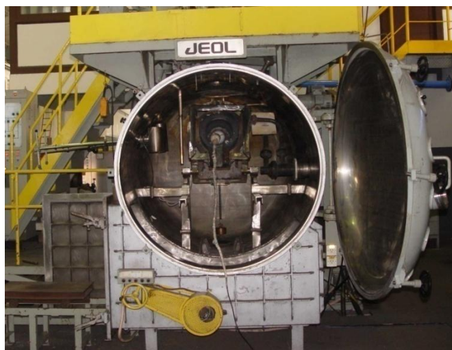
FIGURA 4.1 – Forno de fusão à vácuo utilizado para a fabricação dos lingotes.
