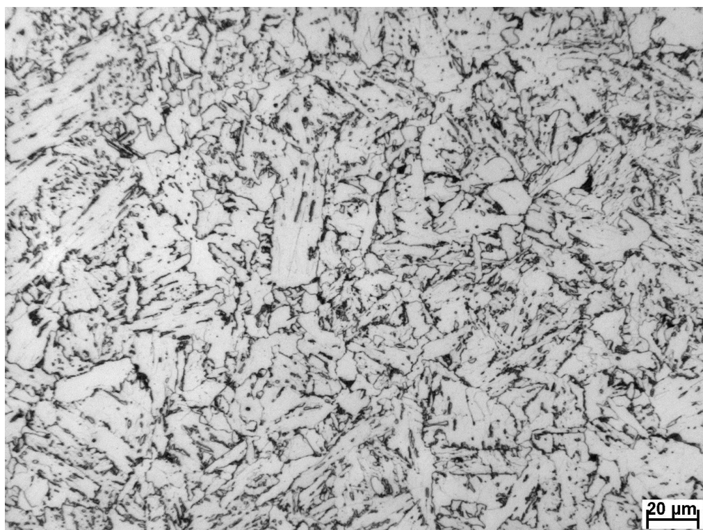
FIGURA 5.55 – Aspecto típico da microestrutura da ICGGZTA do aço LC. HI: 50 kJ/cm; \Delta t_{8/5} = 46 s; T_{\text{pico2}}: 800^{\circ}\text{C} . Aumento: 500X. Ataque: nital 4%.
