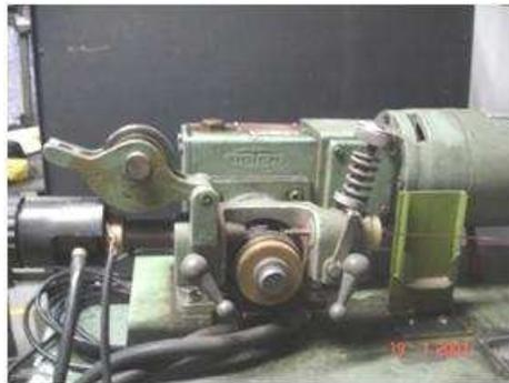
Figura 6.3 - Sistema de roletes responsável pelo arraste do arame (desacoplado).
