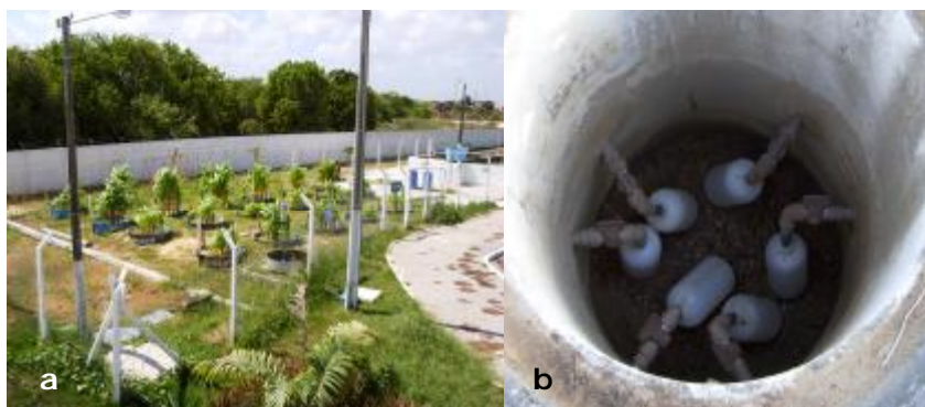
Figura 5.1: (a) Área Experimental para Uso Agrícola de Efluentes e (b) poço de coleta e recolhimento de líquidos lixiviados
