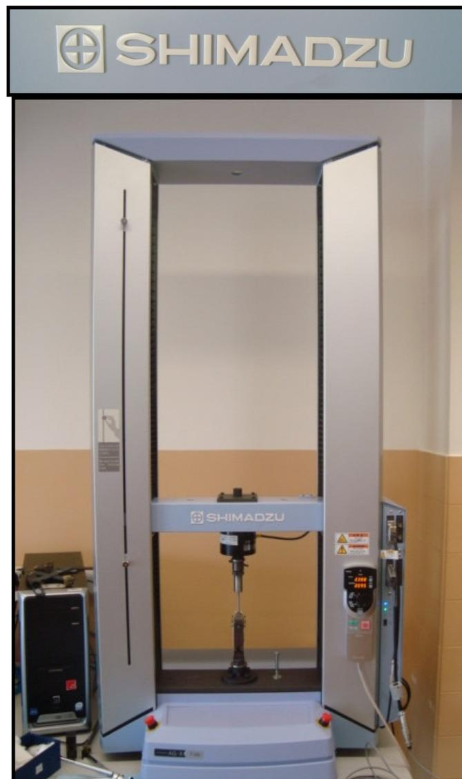
FIGURA 4.1 – Fotografia do aparelho utilizada para os ensaios: Máquina Universal de Ensaio Mecânicos *Shimadzu Autograph AG-1* do laboratório de Engenharia Mecânica da Universidade de Coimbra – Portugal.
