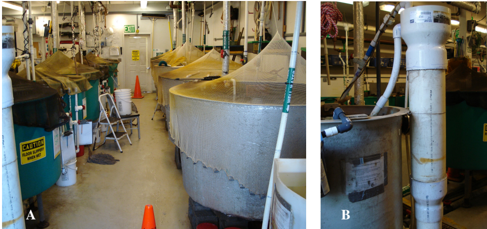
FIGURA 3.2– (A) Vista parcial do laboratório do USBR mostrando os tanques para manutenção dos peixes e (B) o filtro biológico utilizados.
