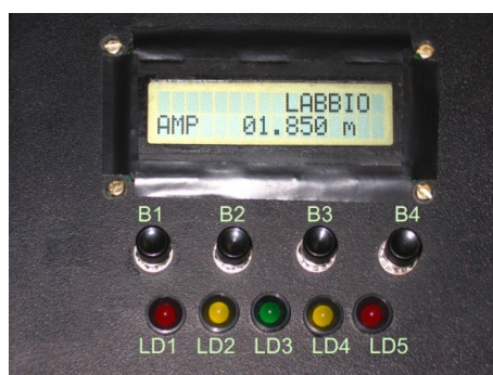
FIGURA 4.5 Caixa de processamento com indicação numérica dos botões e LED's.
