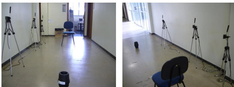
FIGURA 4.7. Disposição das fotocélulas durante teste Funcional “Timed Up and Go “
