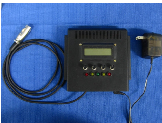
FIGURA 4.4. Cabo de conexão do sensor, Caixa de processamento e fonte de alimentação.
