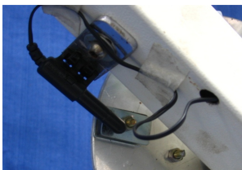
FIGURA 4.3.a. Posição onde o sensor detecta o ímã
